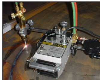
El aditamento para cortes circulares puede cortar círculos desde 25mm (1 in) hasta 2,438 mm (96 in) de diámetro
