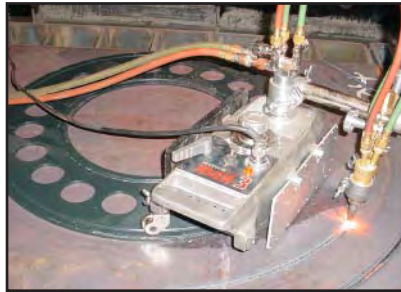
Riel circular Parte # BCD19109 Cortes de 1 1/2 - 14" (40 - 360mm) interior y 30 - 45" (770 - 1,150mm) exterior, se recomienda utilizar contrapeso.
