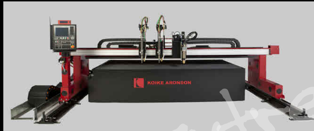
Motores AC con cajas reductoras tipo planetario para un movimiento suave y preciso. La repetibilidad de la maquina es de \pm 0.001" (0.02mm) La precisión de la maquina es de \pm .010 (.25mm) Velocidad maxima de la maquina 800IPM (20,320mm/min)
