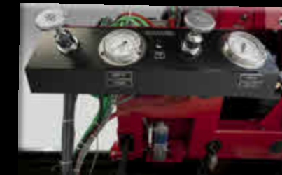
Panel de control de gases Hi-Lo con selector individual de sopletes. La capacidad de sistema es de 4 sopletes cortando 6" (150mm) de espesor.
