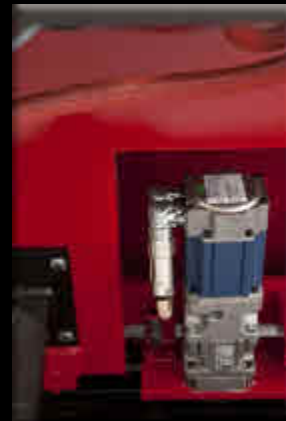
Motores AC con cajas reductoras tipo planetario para un movimiento suave y preciso. La repetibilidad de la maquina es de \pm 0.001" (0.02mm) La precisión de la maquina es de \pm .010 (.25mm) Velocidad maxima de la maquina 800IPM (20,320mm/min)
