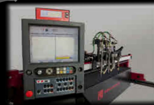
La Estacion de Operación puede ser configurada a la izquierda o derecha para satisfacer los requerimientos del cliente.
