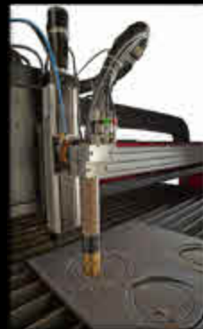
Configuracion de estaciones de corte: Cuatro oxi-corte y Dos plasmas
