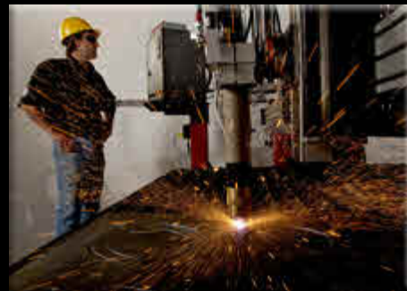
Se Puede configurar un plasma convencional de 100 AMP hasta un plasma de Alta-Definicion de 400 AMP
