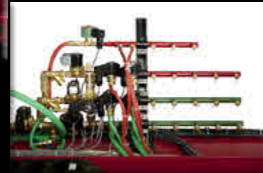
Panel de control de gases Hi-Lo con selector individual de sopletes. La capacidad de sistema es de 4 sopletes cortando 6" (150mm) de espesor.
