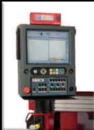
Eleccion de Dos Controladores, KARCNCx o Burny Phantom. Ambos con Servos Integrados
