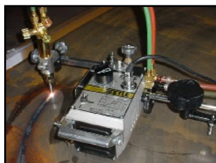
Barra para cortar círculos, Cortes de 38-2450mm (1½ - 96 in) de diametro.
