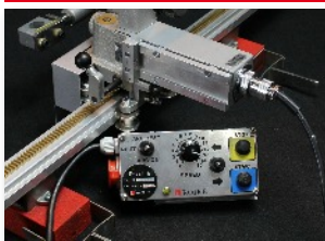
Panel de Operación se muestra fuera de la máquina
