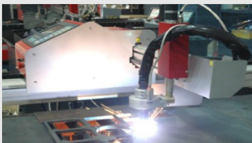
La barra transversal extra ancha y robusta con varilla de acero está sujeta con rodillos de acero.
