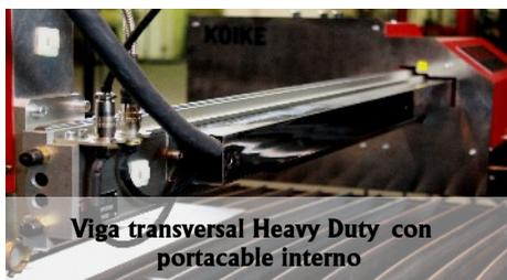
Viga transversal Heavy Duty con portacable interno
