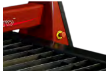
Switch de Parada de Emergencia E-stop ubicado en cada carro lateral, detiene de forma rápida y segura, el movimiento de la máquina y el proceso de corte, incluidos los gases que van al soplete de oxicorte.
