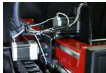
Cajas de engranajes de precisión helicoidales con motores paso a paso NEMA-34.
